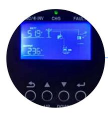
Écran LCD graphique affichant toutes les informations pertinentes sur le mode de fonctionnement, la tension d'entrée, la tension de sortie, la fréquence, la puissance de sortie et le niveau de charge de la batterie
