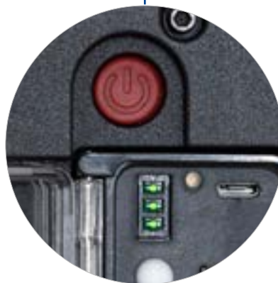
Interrupteur marche/arrêt (Arrêt | 25 | 50 | 100 %) et témoin deniveau de charge
